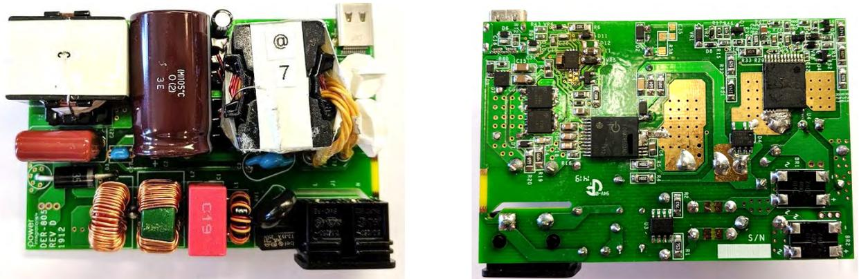
图 6 DER-805 – 无需散热片的100 W宽范围输入USB PD + PPS充电器（5 V – 20 V输出）。使用InnoSwitch3-Pro INN3370C-H302设计而成。
