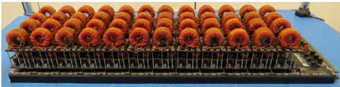
图7 用于PowiGaN InnoSwitch3器件合格性测试的DOPL应力测试板
