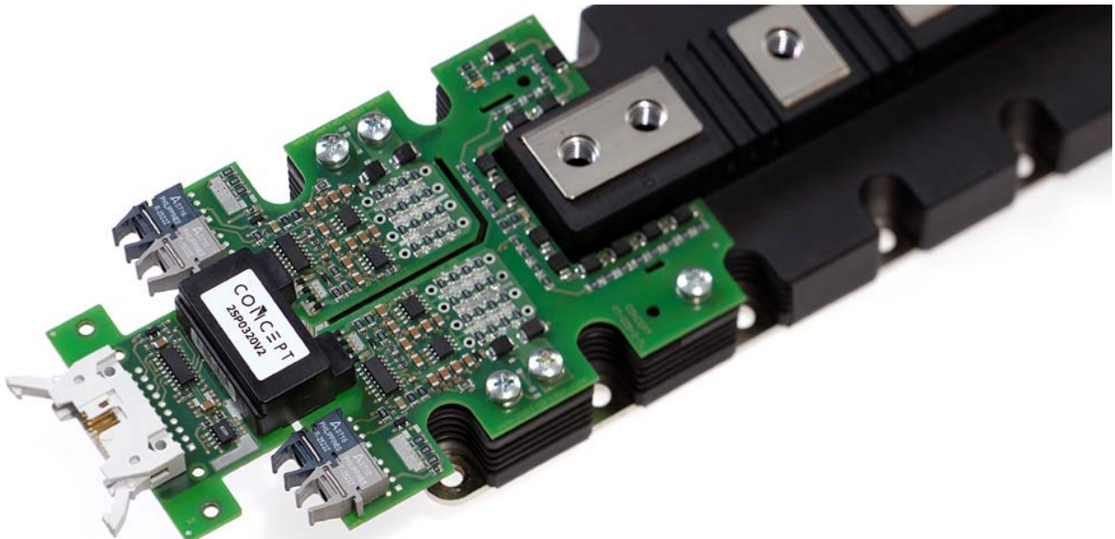
图 1 2SP0320V用螺丝固定到PrimePACK™ IGBT模块上
